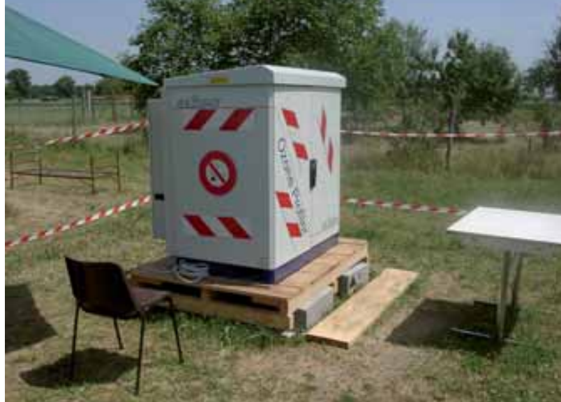
■ Illustration 5.5-10: LIDAR profiler d'ozone vertical utilisé pendant la campagne de mesure (Frejafon, 2003)
